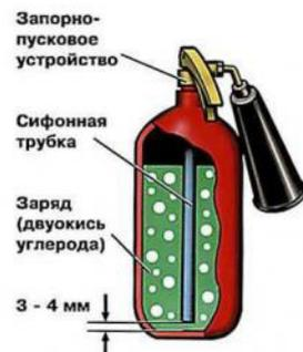
**ПРИНЦИП ДЕЙСТВИЯ** основан на вытеснении двуокиси углерода избыточным давлением. При открытии запорно-пускового устройства  $CO_2$  по сифонной трубке поступает к раструбу и из сжиженного состояния переходит в твердое (снегообразное). Температура резко (до  $-70^\circ C$ ) понижается. Углекислота, попадая на горящее вещество, изолирует его от кислорода
